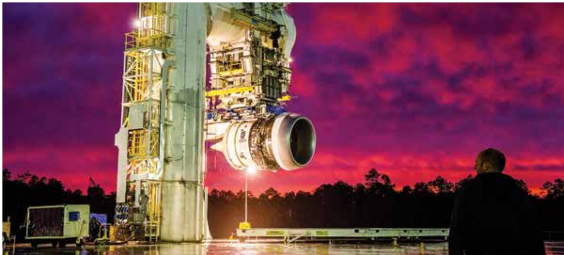
Boeing testet fortschrittliche Triebwerkstechnologien im NASA Stennis Space Center in Mississippi. Innovative Anwendungen von Materialien wie Keramik-Verbundwerkstoffe machen Triebwerke leiser, leichter und effizienter. (Foto: Boeing)
