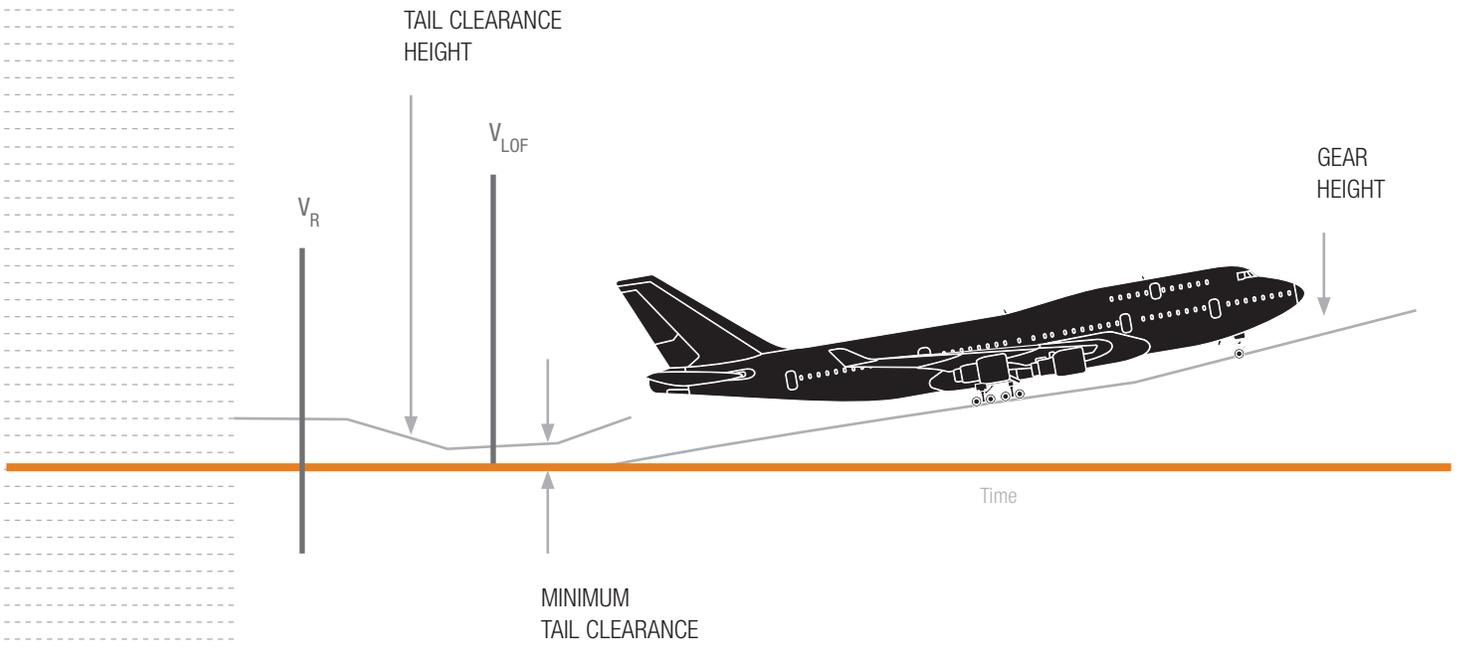
**TYPICAL TAIL CLEARANCE FOR ENGINES-OUT TAKEOFF**
