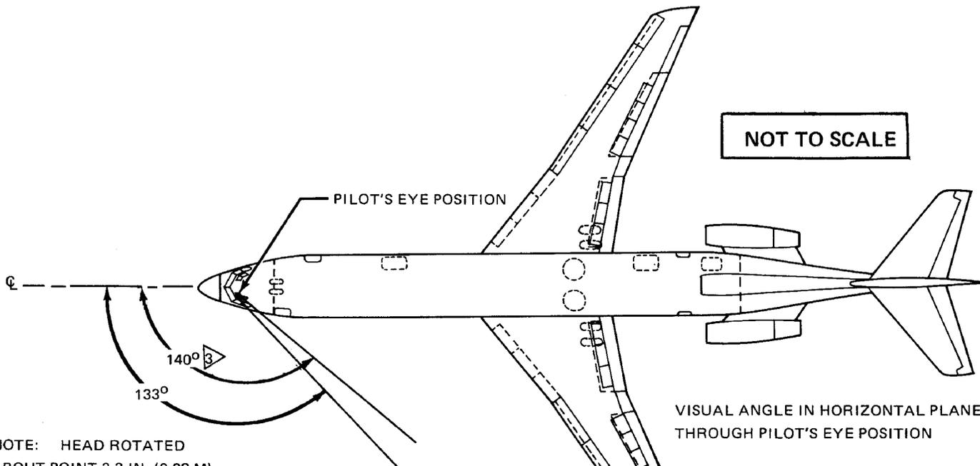
VISUAL ANGLE IN HORIZONTAL PLANE THROUGH PILOT'S EYE POSITION
