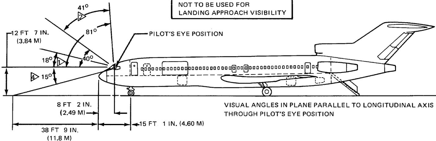
VISUAL ANGLES IN PLANE PARALLEL TO LONGITUDINAL AXIS THROUGH PILOT'S EYE POSITION
