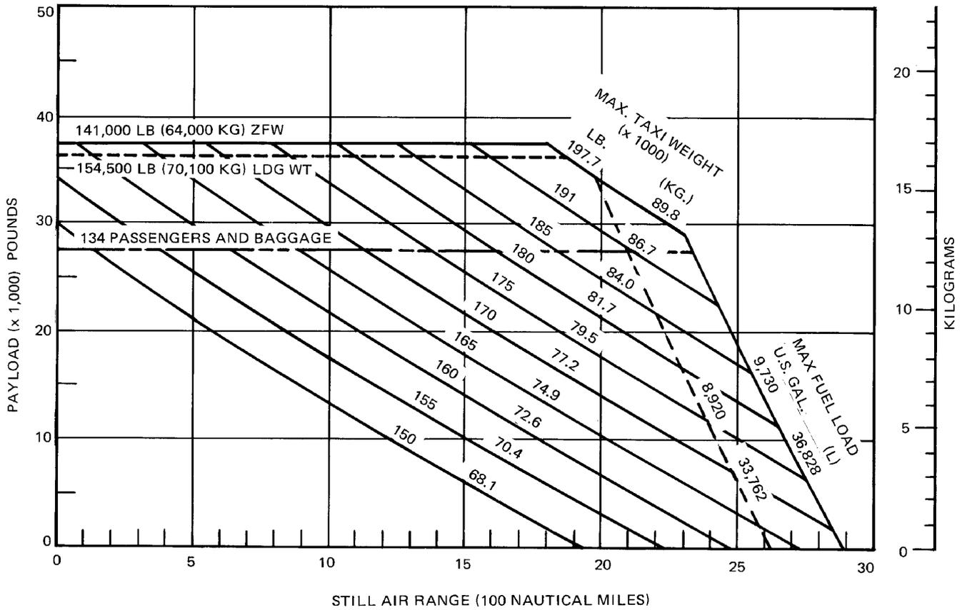
**PAYLOAD/RANGE FOR LONG-RANGE CRUISE—(JT8D-17 ENGINES)**
