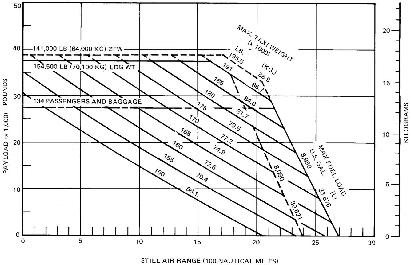
**PAYLOAD/RANGE FOR LONG-RANGE CRUISE—(JT8D-15 ENGINES)**
