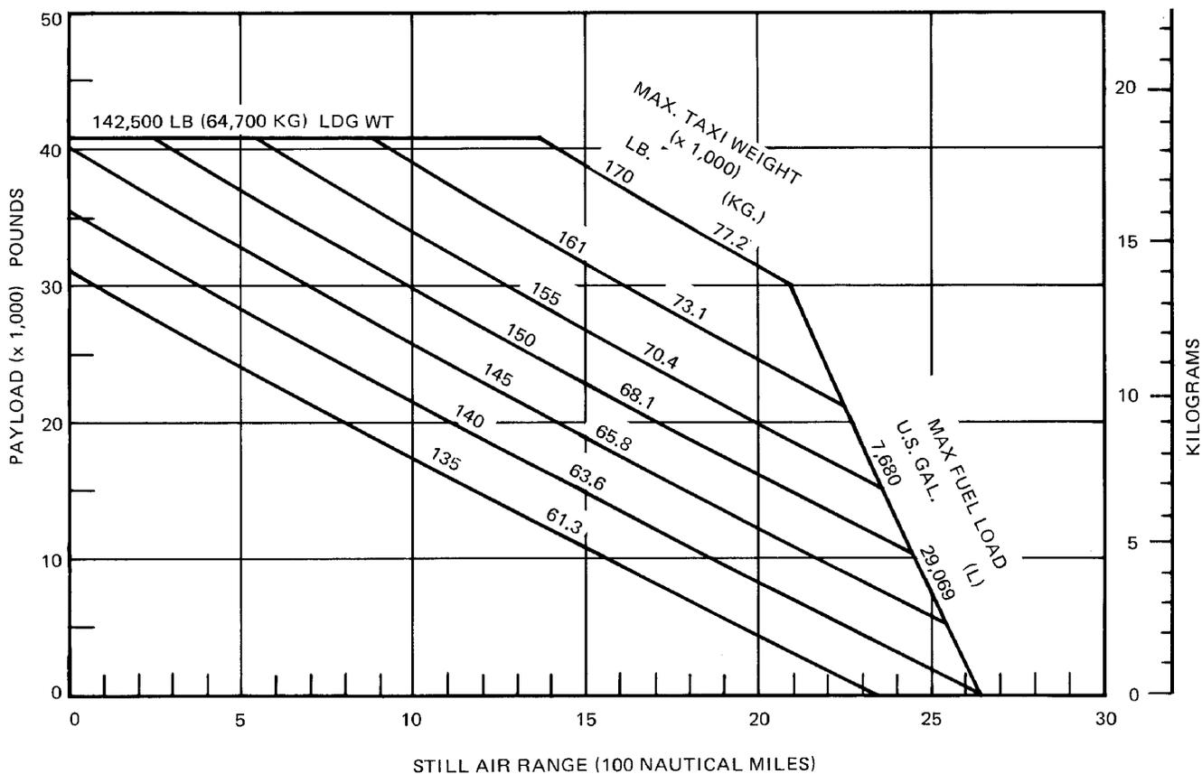
**PAYLOAD/RANGE FOR LONG-RANGE CRUISE—(JT8D-7 OR -9 ENGINES)**
