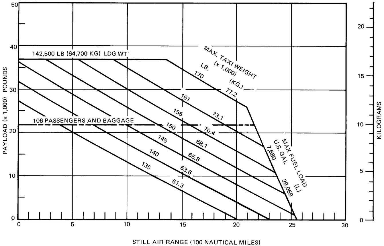
**PAYLOAD/RANGE FOR LONG-RANGE CRUISE—(JT8D-7 OR -9 ENGINES)**
