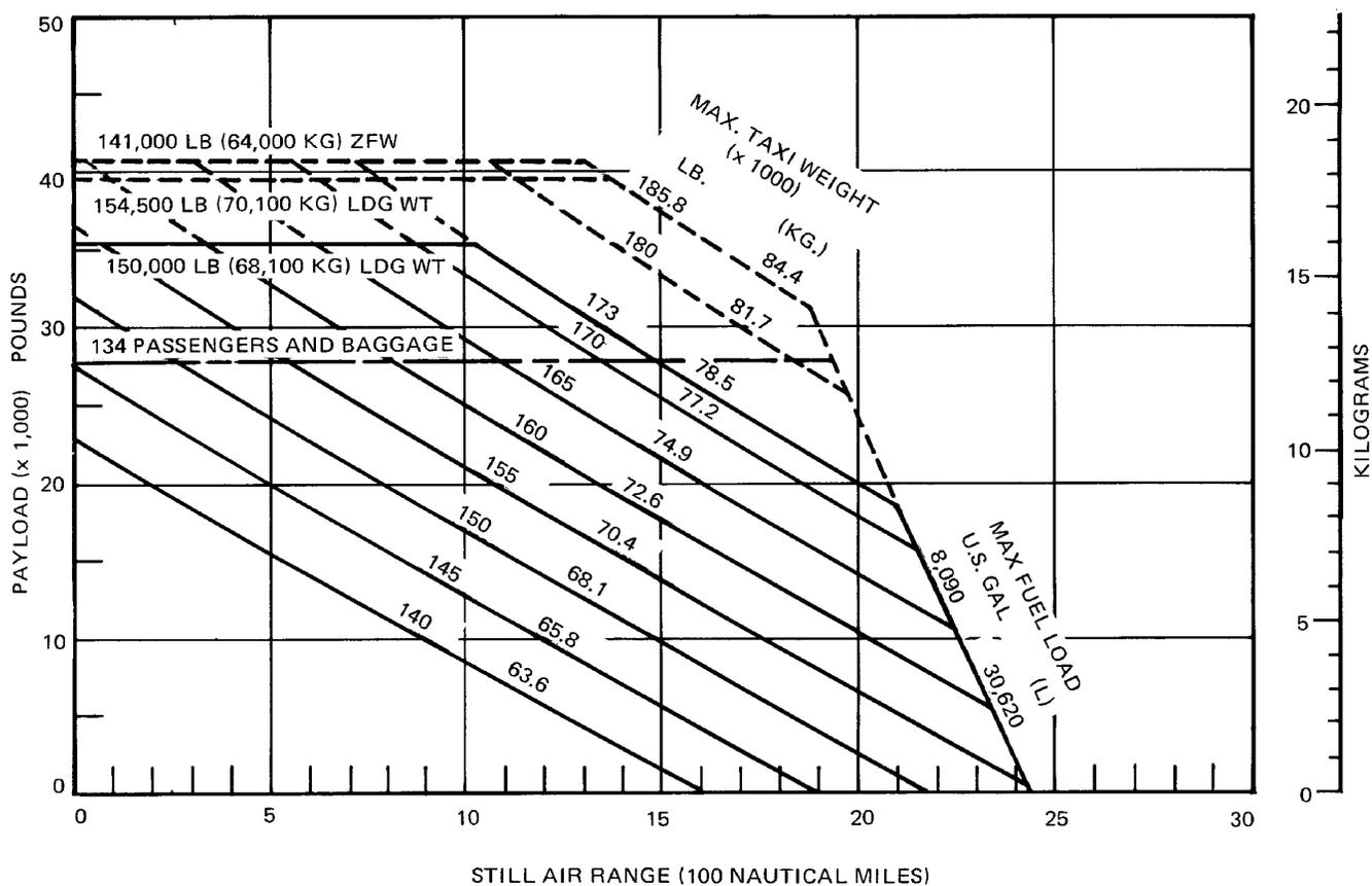
**PAYLOAD/RANGE FOR LONG-RANGE CRUISE—(JT8D-7 ENGINES, STANDARD MODEL).**
