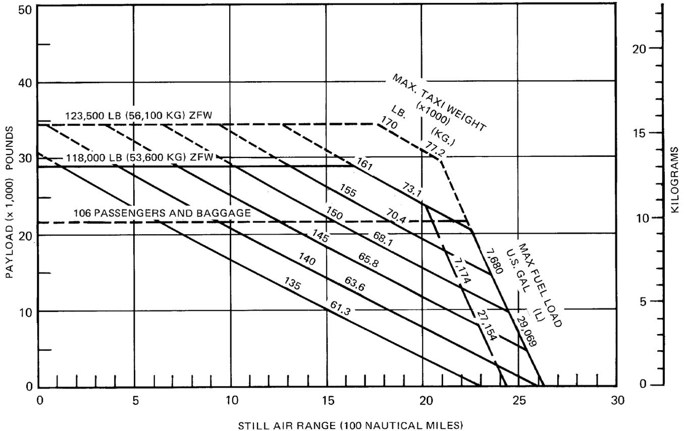
**3.1 PAYLOAD/RANGE FOR LONG-RANGE CRUISE—(JT8D-7 OR -9 ENGINES)**
