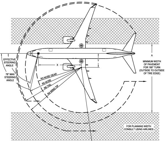
THEORETICAL CENTER OF TURN FOR MINIMUM TURNING RADIUS SLOW CONTINUOUS TURNING AT MINIMUM THRUST ON ALL ENGINES. NO DIFFERENTIAL BRAKING. CONSULT USING AIRLINE FOR SPECIFIC OPERATING PROCEDURES.
